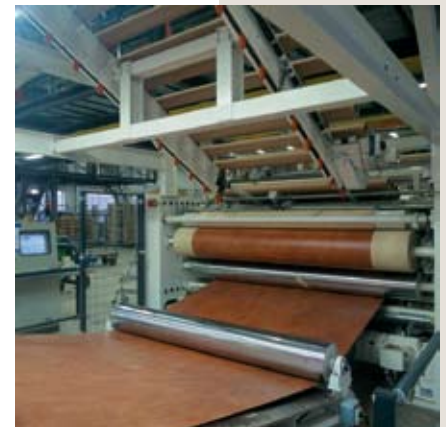
● In één vloeiende beweging wordt de vloerbedekking om een kartonnen kern gewikkeld, op 30 m afgesneden, met papier omwikkeld, van kopvlakken voorzien, vastgeplakt en op transport gezet
